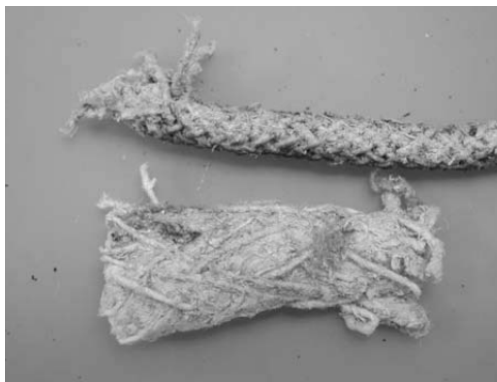
Asbestschnüre. Verwendung zur Abdichtung an brandgefährlichen Stellen.
