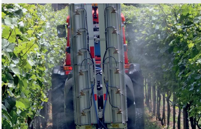
Einsatz von Flachstrahl-Injektordüsen in einer Spalieranlage.
