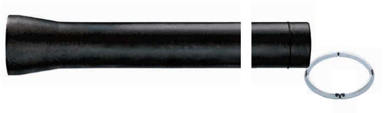
Bei Verwendung von längskraftschlüssigen Gussrohrsystemen der Produktlinie ALPINAL® sind **keine Betonwiderläger erforderlich**. Die auftretenden Längs- und Querschubkräfte werden hierbei über die jeweilige bewegliche, längskraftschlüssige Muffenverbindung aufgenommen.
