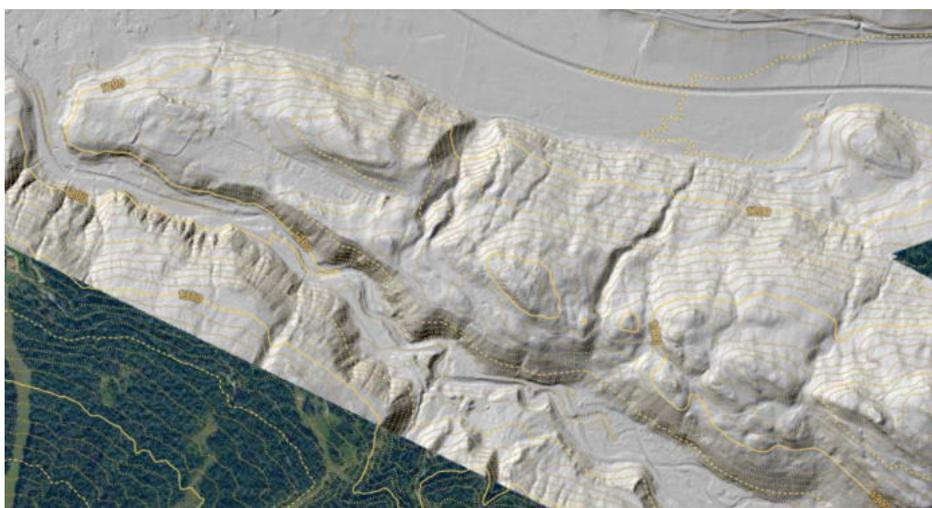
**Figura 10.** Curve di livello e DTM 0,5 m sfumato per l'area estesa di progetto.
