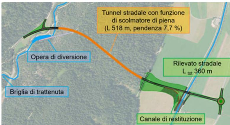
Figura 43. Localizzazione planimetria delle principali opere in progetto.
