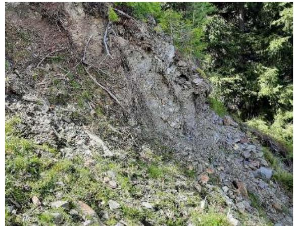
*Foto 8: Stark aufgelockerter Quarzphyllit direkt bergseitig der bestehenden Mittelstation.*
