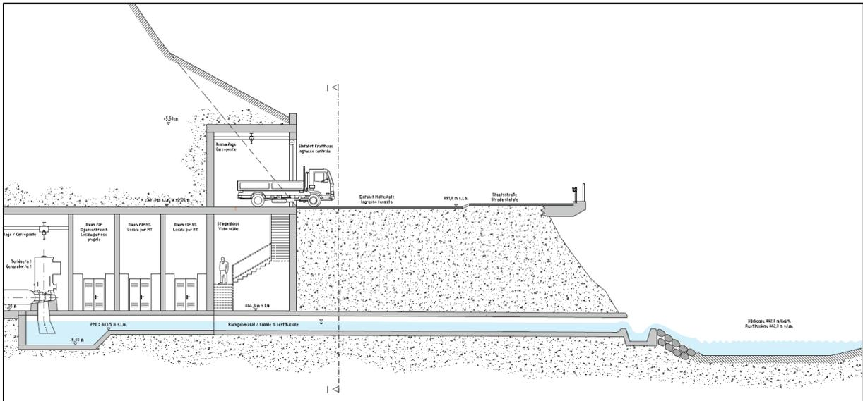
Abb 5: Schnitt durch das Krafthaus und den Rückgabekanal
