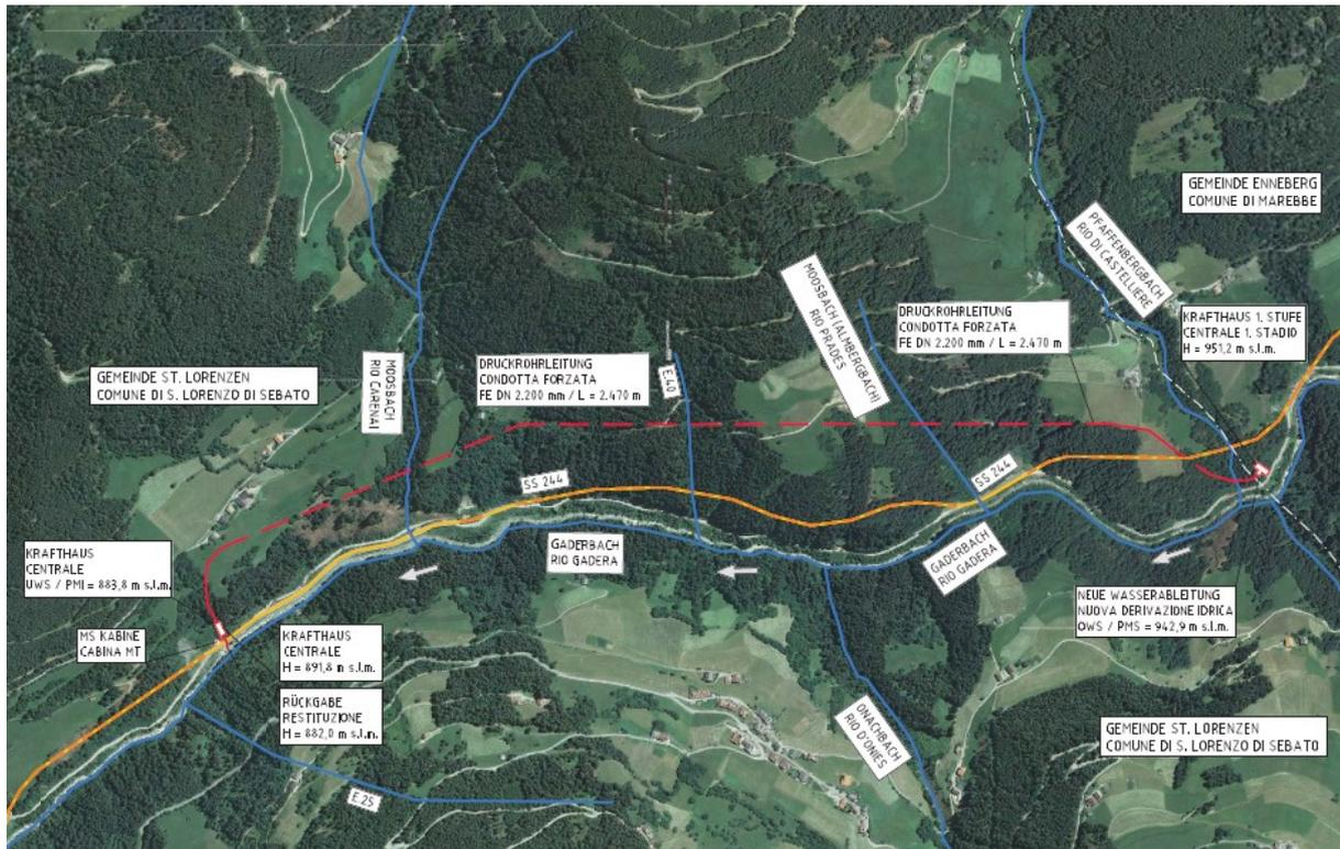
Abb 3: Verlauf der Druckrohrleitung orographisch rechts
