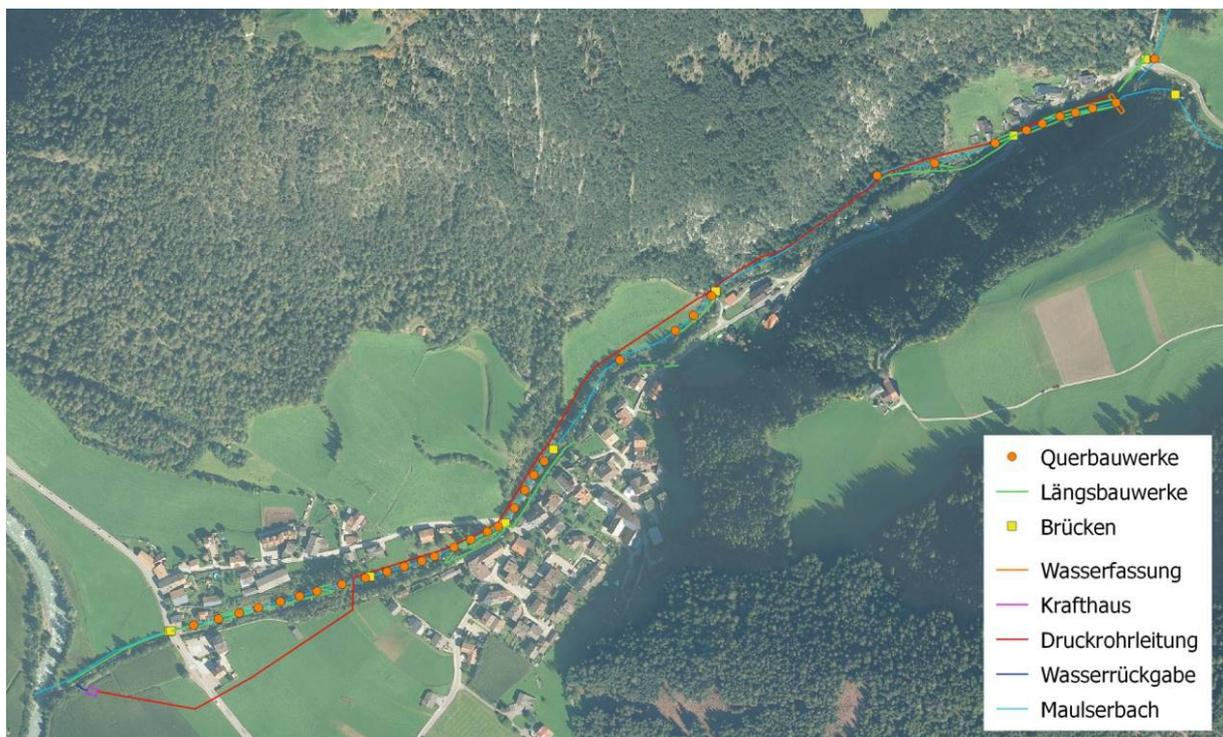
Abbildung 11: Bestehende hochwasserschutztechnische Verbauung am Maulserbach
