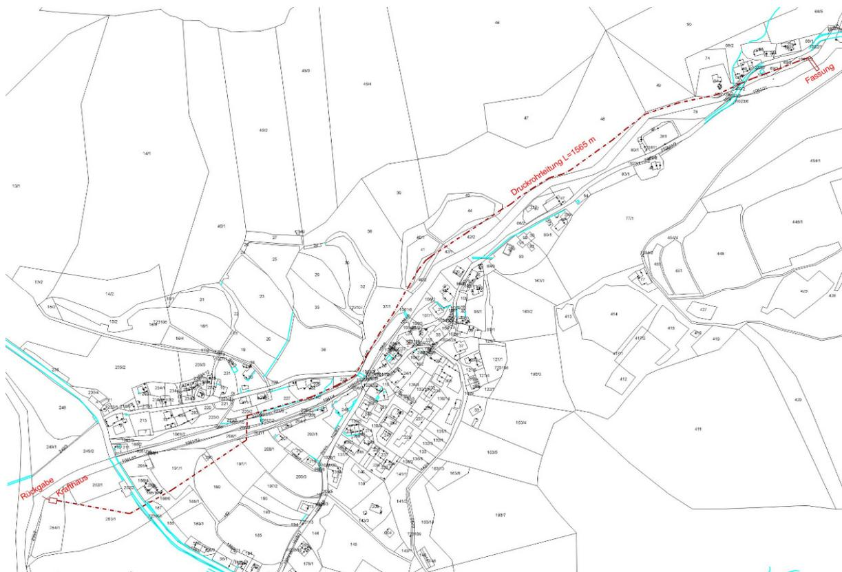
Abbildung 2: Projektgebiet mit Fassung, Druckrohrleitung, Krafthaus und Rückgabe
