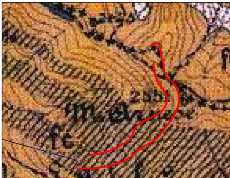
Abb 1: geologische Karte (Carta geologica D'Italia) mit Trasse der geplanten Aufstiegsanlage und Verlauf der
