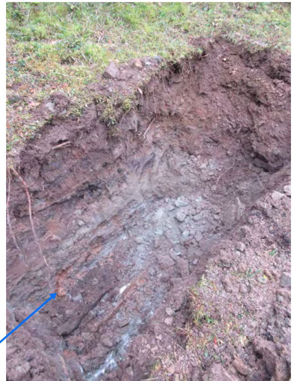
Baggerschurf Sc4 / scavo geognostico Sc4
