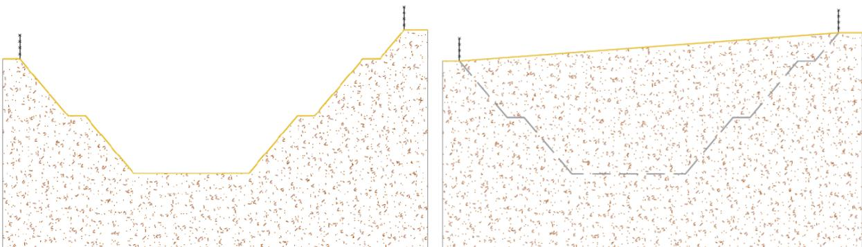
Abbildung 10: Regelquerschnitte der Abbauphase und Wiederverfüllung der Fläche B
