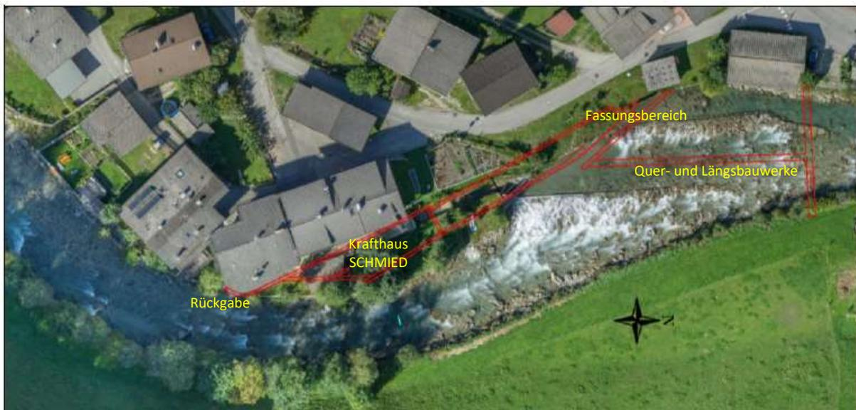
*Kraftwerk SCHMIED: es ist vorgesehen die bestehenden Strukturen des alten E Werkes komplett abzutragen. In diesem Zuge werden auch die ca. 8,5m in den Bachraum hineinragenden Gartenbereiche mitsamt den dazugehörigen Ufermauern abgetragen.*
