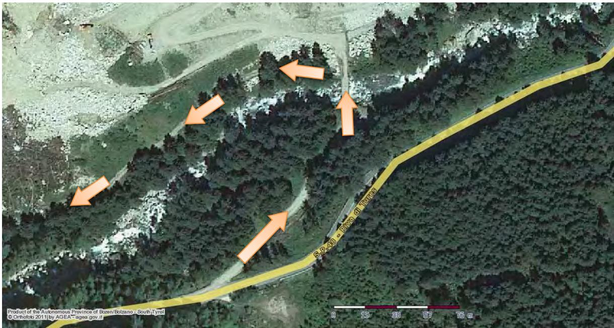
Dal ponticello esistente, si dipartono le rampe di servizio che permettono ai mezzi di scavo e traposto di raggiungere tutte le zone dell'area da coltivare. Per raggiungere la cava "Kröpfler" si utilizza la strada forestale esistente parallela al torrente.
