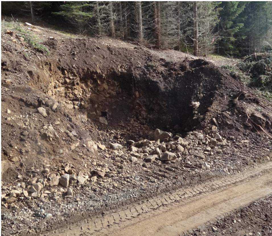
Foto 4: Fels (zerlegte Vulkanite) und darüber geringmächtiger Verwitterungsschutt in einem Schurf an der bergseitigen Böschung der Piste Pilat im Projektgebiet, Blick Richtung NE
