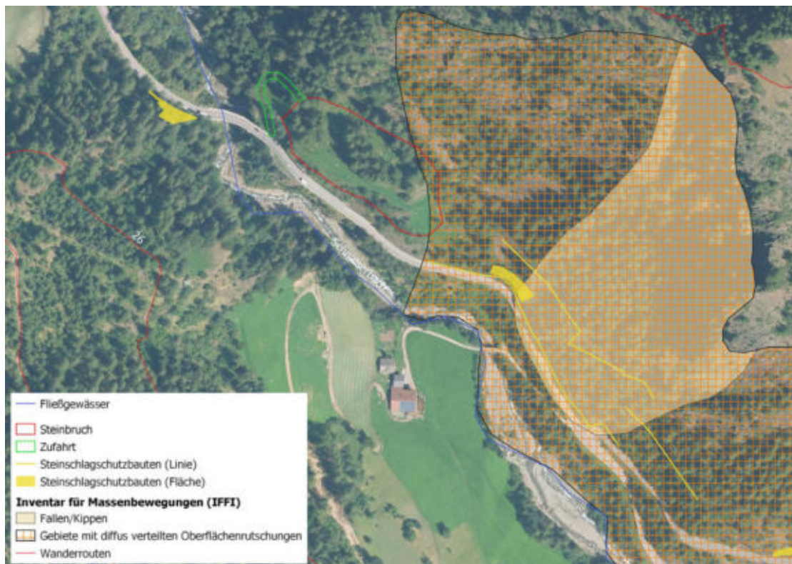
Abbildung 9: Steinschlagschutzbauten und Massenbewegungen im Untersuchungsgebiet (Geobrowser)
