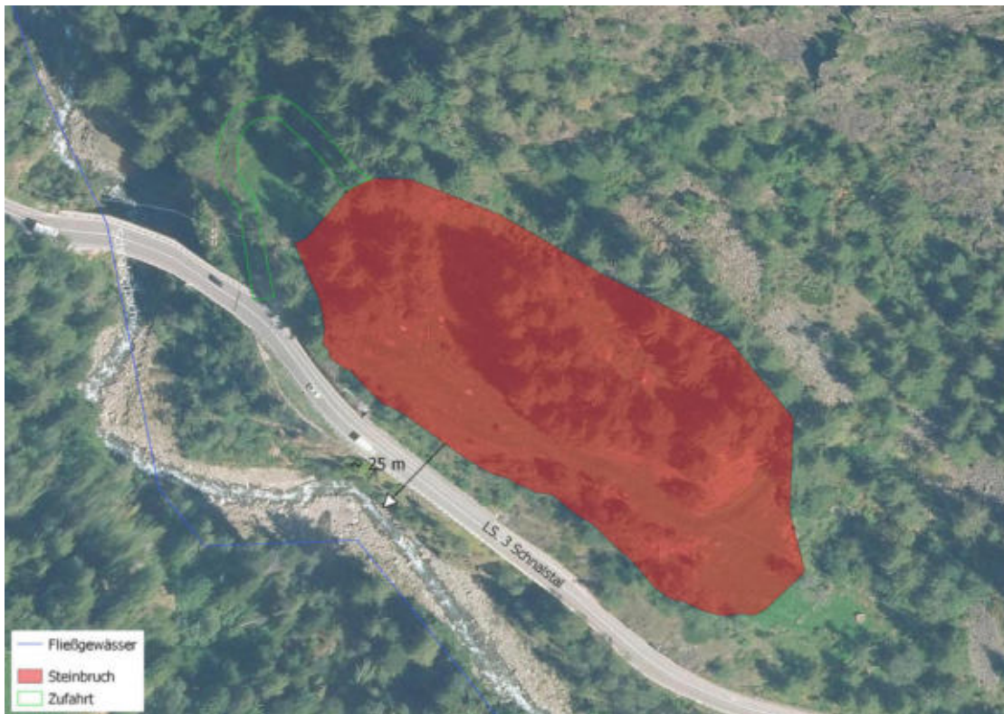
Abbildung 8: Minimale Entfernung des Abbaugbiets zum Schnalserbach - Landesstraße dazwischen
