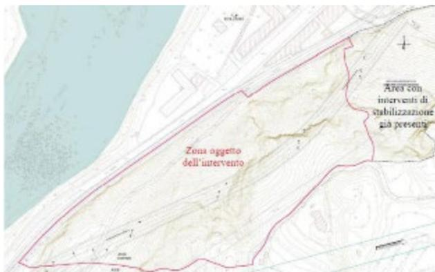
Figura 4 – Interventi di stabilizzazione del versante: ubicazione delle aree di intervento del presente progetto ed aree oggetto di precedenti interventi
