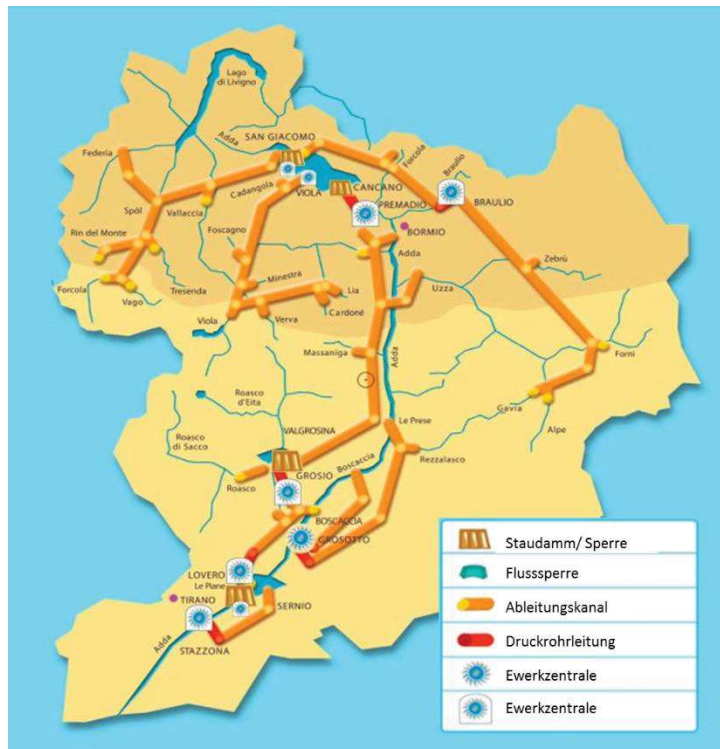
Schema der Wasserkraftanlage A2A im Veltlin (Quelle: A2A)
