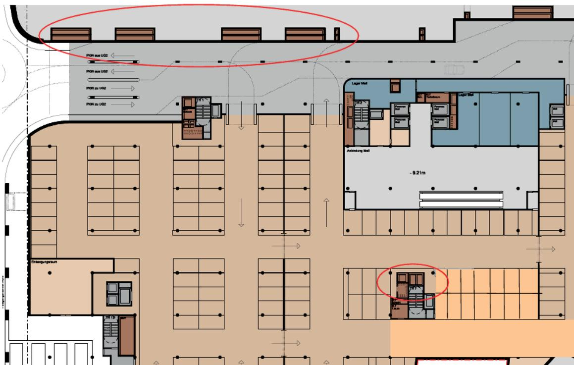
**Abbildung 72: Belüftungsschächte an der Außenseite des Gebäudes und die Entrauchungsschächte in der Mitte des Gebäudes**
