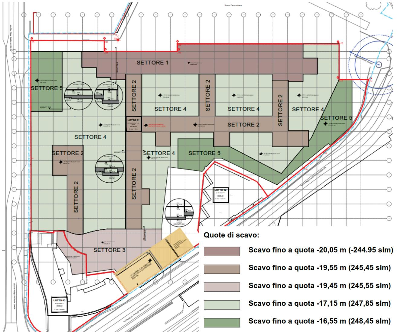
Fig 1.: Planimetria con indicazione delle quote di fondo scavo
