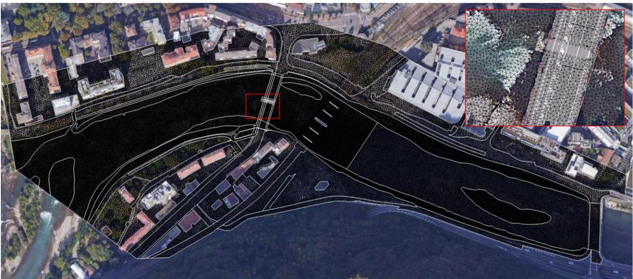
Abbildung 2: Berechnungsgitter hydrodynamisches 2D-Modell.
