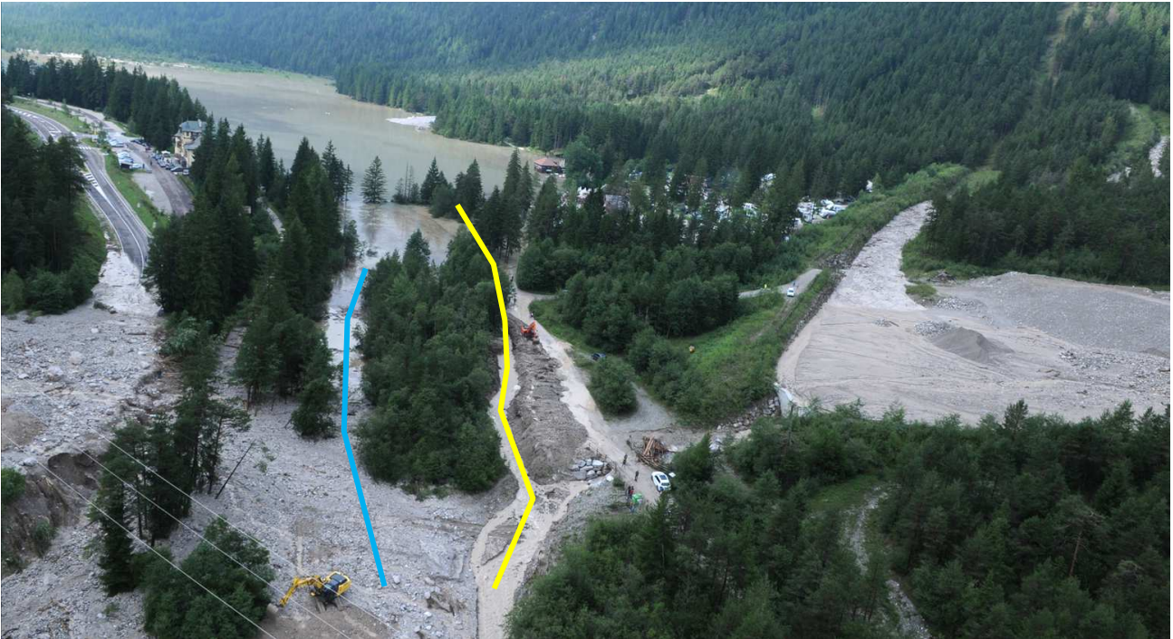
Figura 14: l'imponente colata detritica sul fossato Gosse (a sinistra) ha completamente invaso la strada statale Alemagna e provocato l'occlusione della Rienza (linea blu continua) a valle del Lago di Dobbiaco, il cui livello è aumentato in maniera significativa. La colata del rio Troghe (nella parte destra della foto) è rimasta confinata nel bacino di trattenuta. In giallo il canale scavato per scaricare il lago
