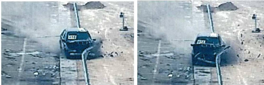
Plasticizzazione alla base dei montanti infissi PAB N2 T2 senza sfilamento
