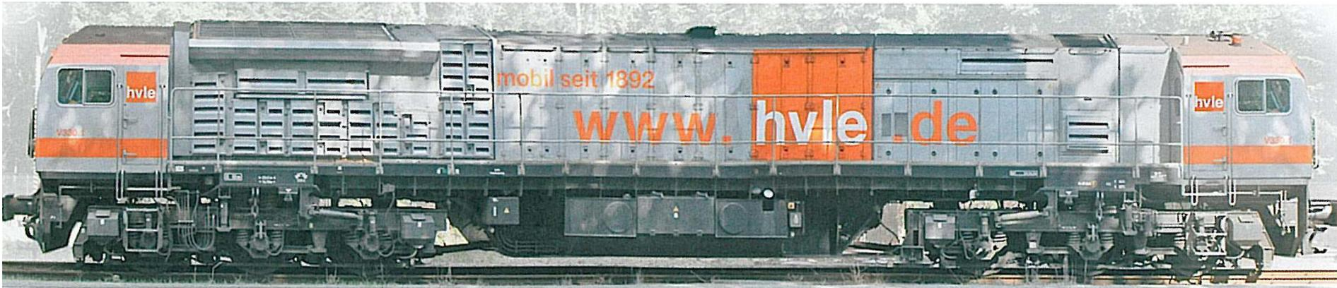
Leistung 2500 kW, Anfahrzugkraft 517 kN,  $V_{max}$  120 km/h, Masse 126 t, Länge 23410 mm, 4 Loks bewährt seit 2008
