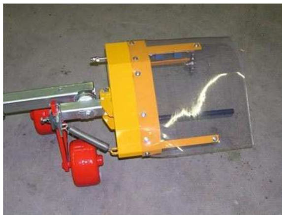
Abb. 4: Herbizidbalken mit Abdeckung
