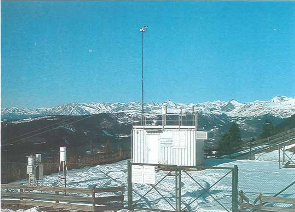
Fig. 30 - Reinluftmeßstation am Rittner Horn
