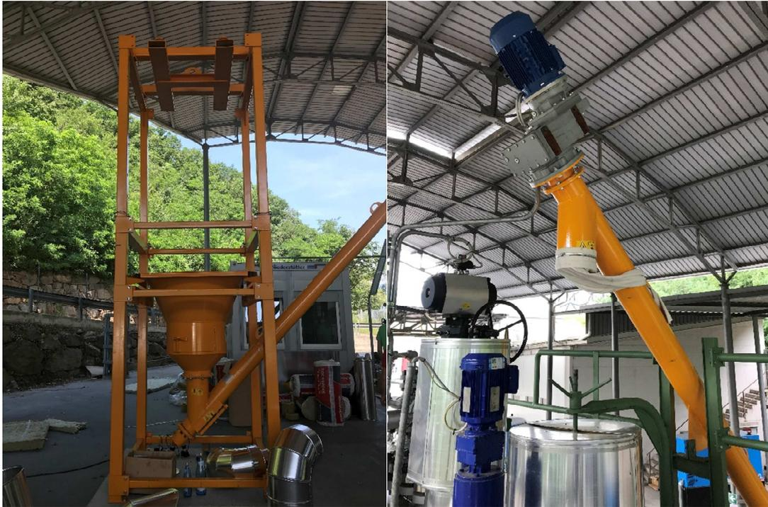
Figura 1. Sistema di caricamento con coclea per inserimento materiale nel reattore.
