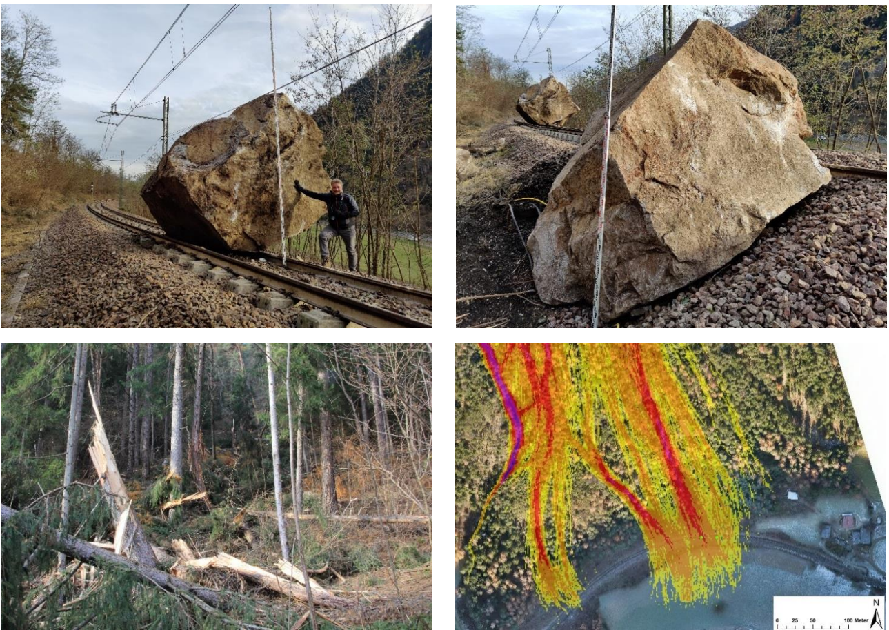
Figura 18: Sopra a sinistra e a destra i due blocchi crollati, che si sono fermati sulla linea ferroviaria. Nell'immagine in basso a sinistra, alberi spezzati lungo la traiettoria di crollo, nonché i risultati delle simulazioni di caduta massi sulla base dei quali sono state definite la posizione, la forma e l'altezza dei tomi-valli paramassi. Si notino i due punti verdi che indicano la posizione dei blocchi crollati. I risultati della simulazione rispecchiano quindi molto bene la realtà, soprattutto perché indicano anche un'alta probabilità di raggiungimento (colori rossi) in quest'area
