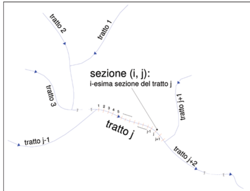
Abb. 2-13: Schematische Darstellung des hydrografischen Netzes im Tal: Jeder Ast ist mittels eines Indexes, jeder Querschnitt mittels eines Wertepaars (i,j) charakterisiert.
