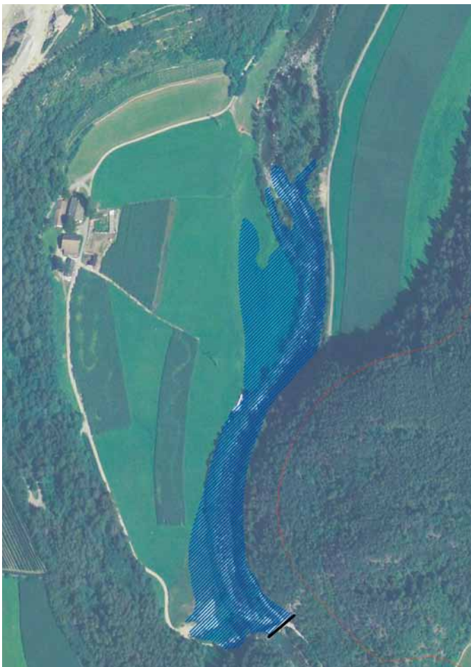
Tav. 4-6: Laminazione delle piene in Val di Riga (bozza di idee).
